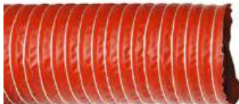
Fibra vidrio+Silicona+Acero -55°C a +260°C
