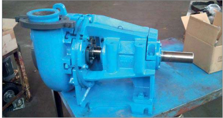
Reparación bomba Svedala MM150
