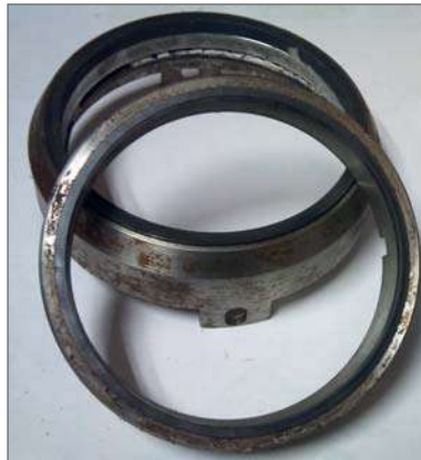
Reparación cierre Latty doble Ø155mm (Equipo Gyroclean)
